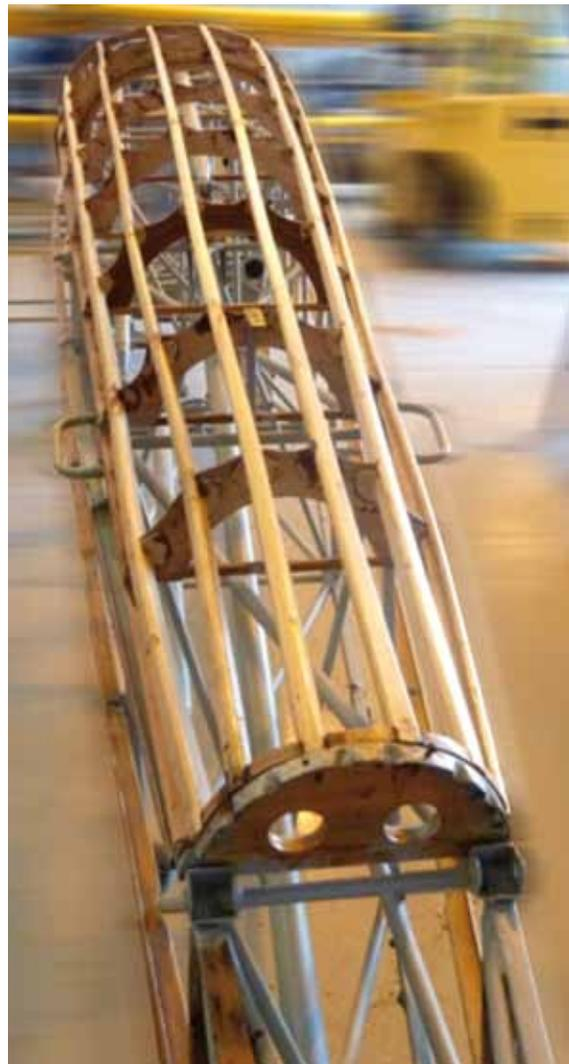
*Fuselaje con larguerillos de madera de conformación aerodinámica instalados sobre la estructura de tubos de acero*
