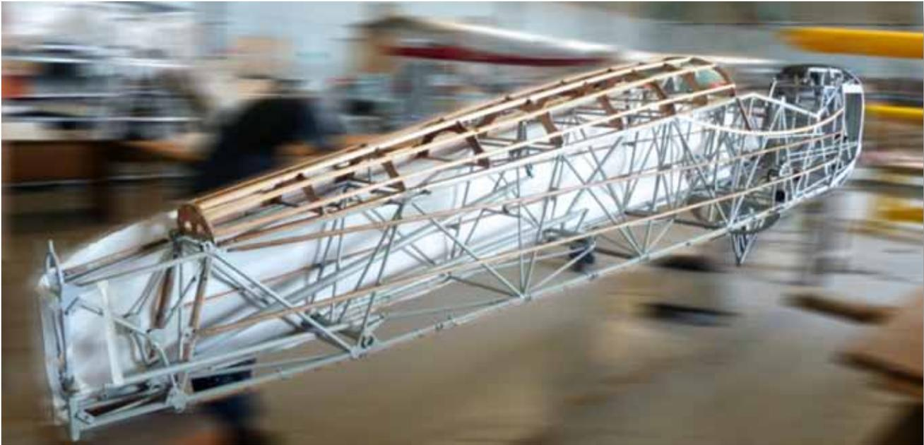
*Estructura de tubos de acero soldados del fuselaje antes de instalar larguerillos de madera de conformación y entelar*
