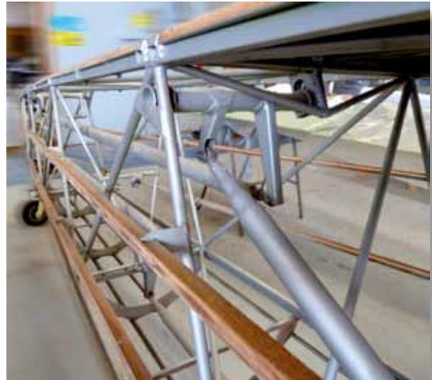
*Barras de accionamiento elevador, en el extremo rodamientos autoajustables*
