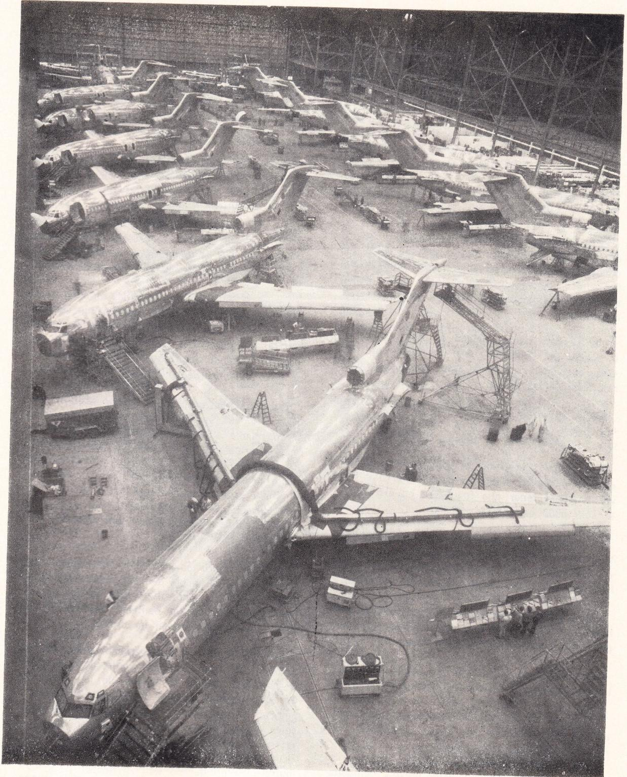
Línea de montaje de aviones B-727.
